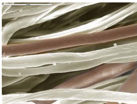
Obr. 2 Zmes bavlnených vlákien pokovovaných oxidom medi a neupravených vlákien podľa SEM.
